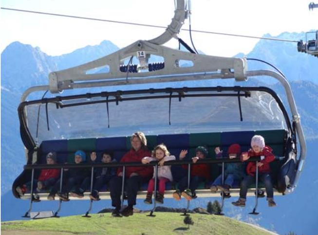
Die derzeit modernste 8er Sesselbahn ist speziell für Familien und Kinder ausgelegt. Den 100% sicheren Transport der Skifahrer gewährleistet ein Sicherheitsbügel. Dieser schließt in der Talstation vor der Abfahrt automatisch und öffnet erst wieder beim Aussteigen in der Bergstation. Somit ist ein Absturz aus dem Sessel während der Fahrt ausgeschlossen.
